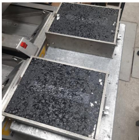
Рис. 5. Образцы-плиты после проведения испытания на колееобразование
