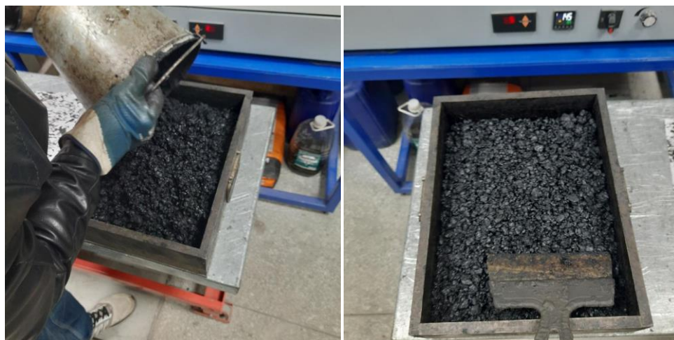
Рис. 2. Этапы распределения массы асфальтобетонной смеси
