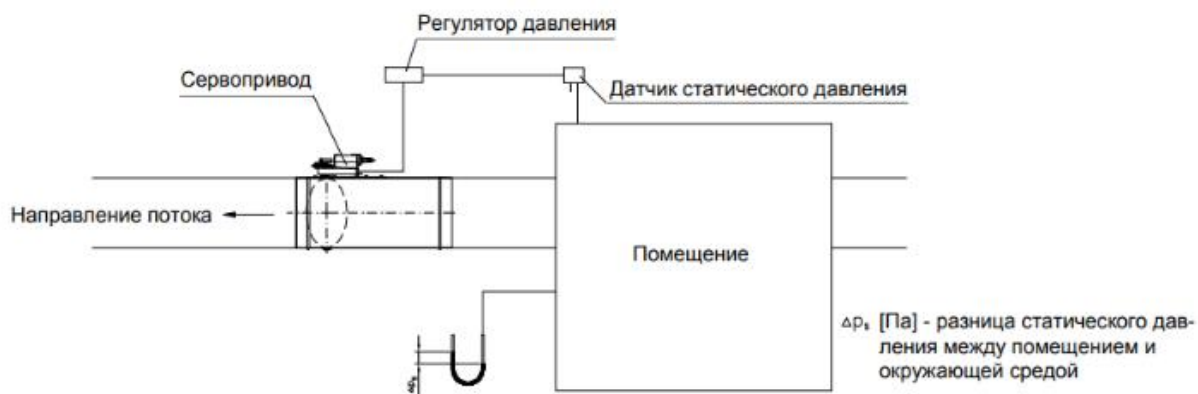
Рис. 3. Схема работы VAV-клапана, регулирующего давление в воздуховоде
