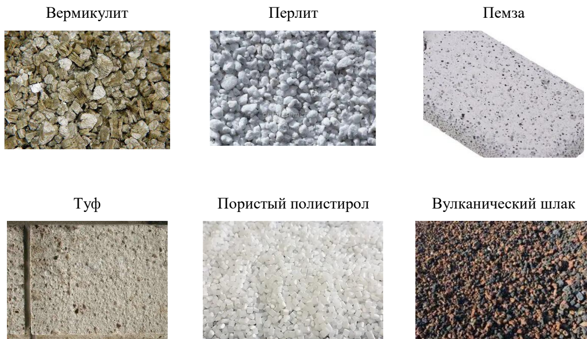
Рис. 4. Заполнители для особо легких бетонов
