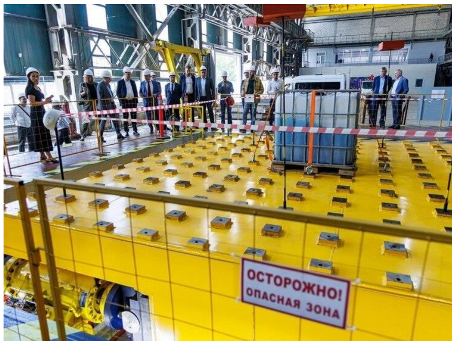
Рис. 2. Сейсмоплатформа для испытаний макетов зданий на сейсмоустойчивость (фото предоставлено МГТУ им. Баумана)
