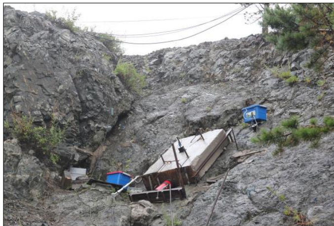
Рис. 1. Устройство испытательного стенда «Трибо», размещенное на фрагменте плоскости Ангарского разлома
